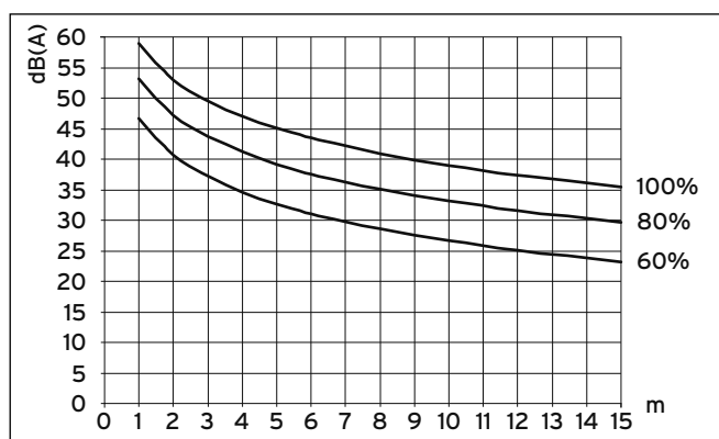
Sl. 6.5 Nivo zvočnega tlaka zunanje enote v dB(A) v odvisnosti od oddaljenosti in števila vrtljajev ventilatorja za VWL 171/3 S pri namestitvi na prostem
