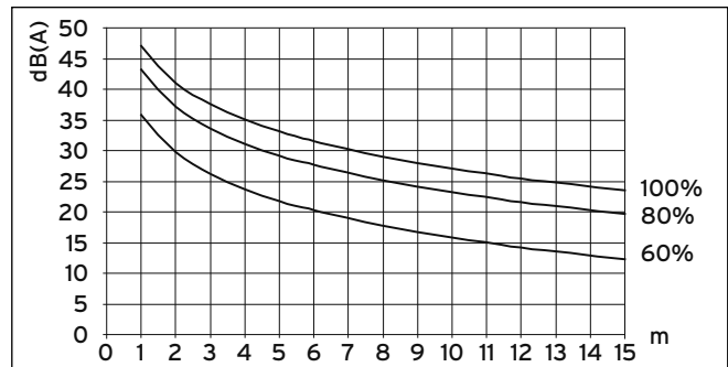
Sl. 6.1 Nivo zvočnega tlaka zunanje enote v dB(A) v odvisnosti od oddaljenosti in števila vrtljajev ventilatorja za VWL 61/3 S pri namestitvi na prostem
