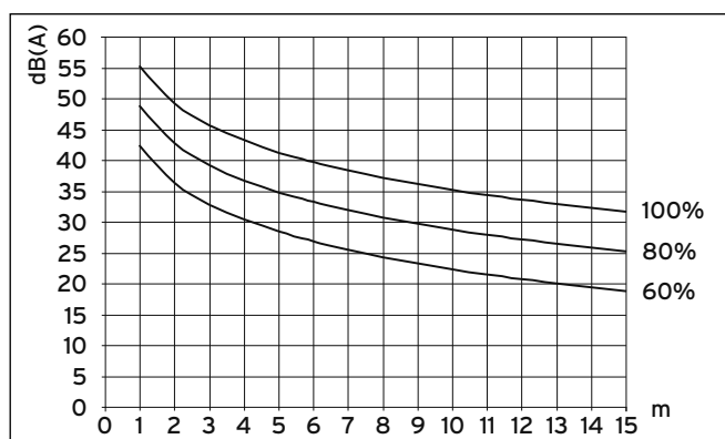
Sl. 6.4 Nivo zvočnega tlaka zunanje enote v dB(A) v odvisnosti od oddaljenosti in števila vrtljajev ventilatorja za VWL 141/3 S pri namestitvi na prostem
